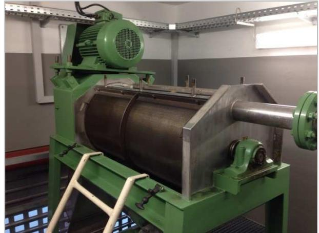
**Bild 4:** Entkernungsmaschine
